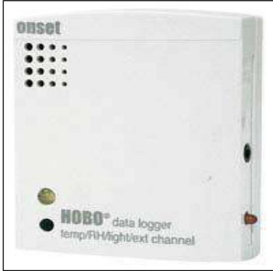
شكل (٣-١١) شكل جهاز (Hobo data logger)
