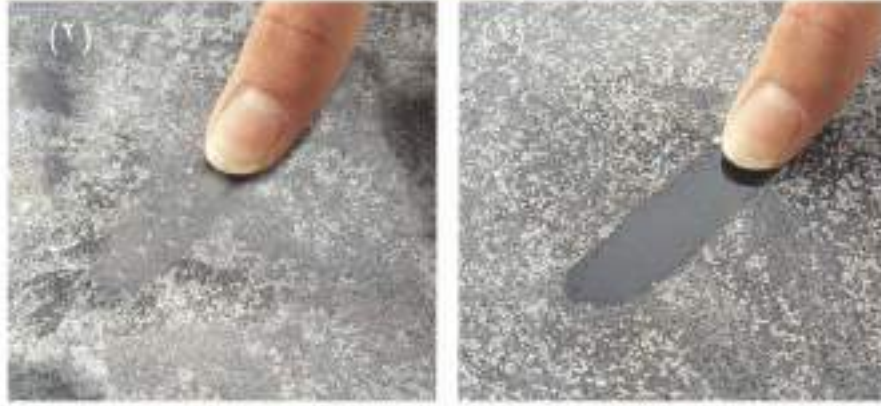
شكل (٢٤-٤) مقارنة بين الاسطح المعالجة بسهولة التنظيف (ETC) (١) - والاسطح الغير معالجة (٢) Source :Leydecker, Sylvia , Nano Materials in architecture, Interior architecture and Design, (2008), p (92-94)
