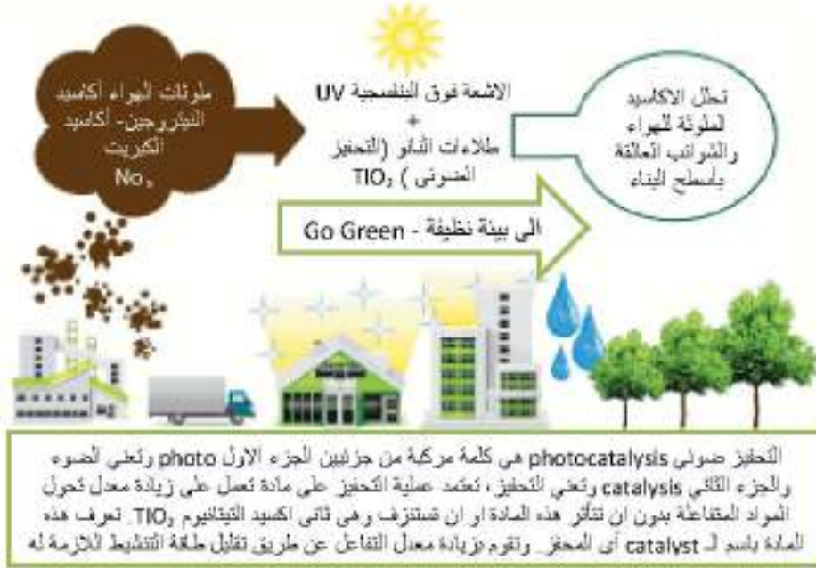
شكل(١٨-٦) التغير المباشر لطلاءات النانو (التحفيز الضوئي) على لسطح البناء و عمليات تنقية الهواء بوجود اشعة الشمس فوق البنفسجية المصدر : الباحث ٢٠١٥
