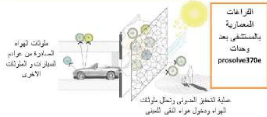
شكل (٥-٣٦) الواحيت المعمارية للمستشفى تكالغ ملوثات الهواء وتعمل على تنقية المصدر : بتصريف الباحث
