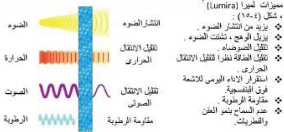
شكل (٤-١٥) مميزات لميرا (أيروجل) (aerogel) (Lumira)
