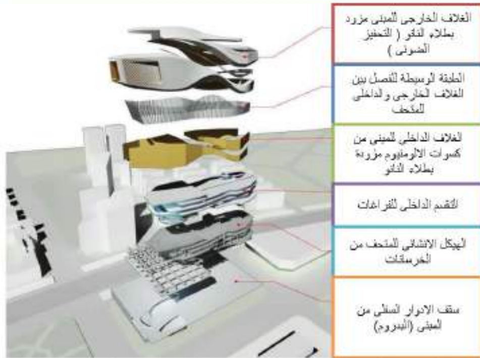
شكل (٥٦-٥) الغلاف الخارجي والداخلي للمتحف والطبقات الوسيطة لاعطاء عزل حراري وصوتي المصدر: بتصرف الباحث
