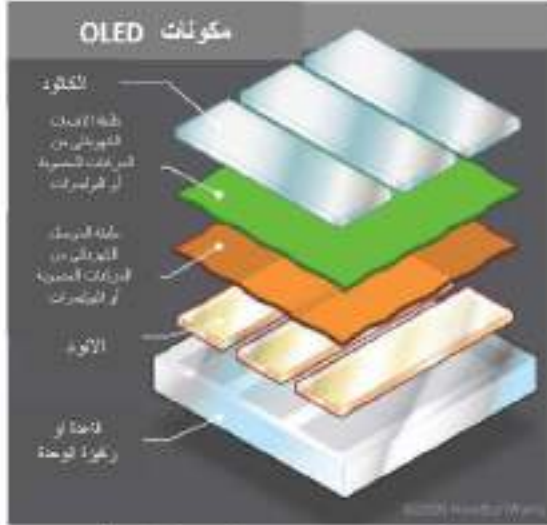
شكل (٣٤-٤) مكونات شاشة الصمام الثنائي العضوي الباعث للضوء (OLED) المصدر : بتصرف الباحث George Elvin ,Nanotechnology for Green Building (2007),p 45
