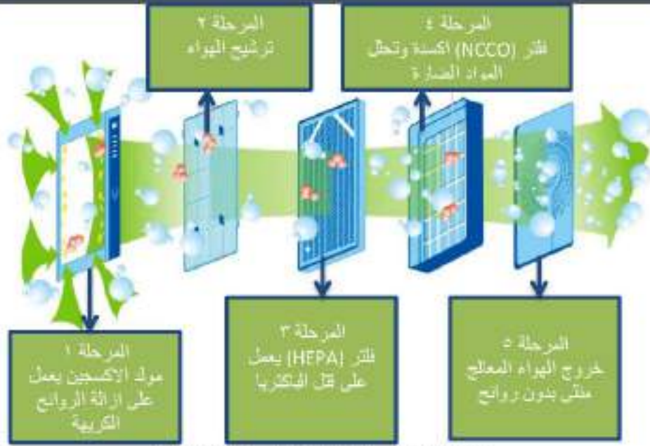
شكل (٤-٣٧) مراحل تنقية الهواء بنظام (NCCO) المصدر: بتصريف الباحث
