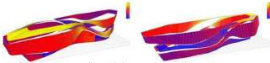
شكل (٥٩.٥) دراسة الاحمال الحرارية للمبنى
