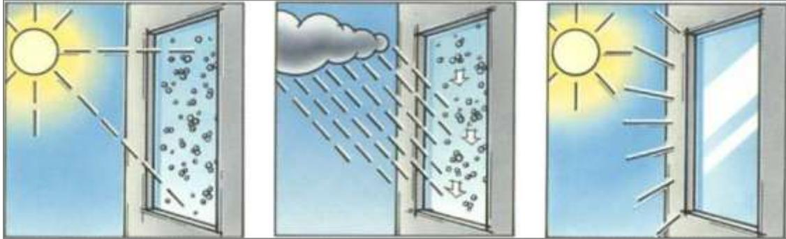
شكل (٥-٢٢) يوضح أنه عند تعرض الزجاج الخارجي للمبنى لأشعة الشمس و الهواء و مياه الأمطار فإن تقنية التنظيف الذاتي ب *photocatalysis* تعمل بكفاءة عالية. المصدر: Sylvia Leydecker, **Nano Materials in Architecture, Interior Architecture and Design**,pg 74 بتصرف
