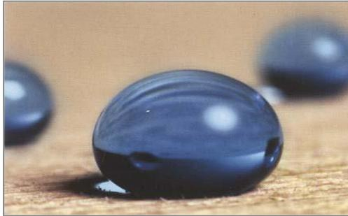
شكل (٤-١٦) سطح الخشب من الممكن أن يعطي نفس السطح المطلوب في تقنية التنظيف الذاتي إذا أضيفت آلية مثل النتوءات التي على أسطح أوراق نبات اللوتس، وفي الصورة شكل قطرة الماء على سطح خشبي. المصدر: Sylvia Leydecker, pg 67 بتصرف
