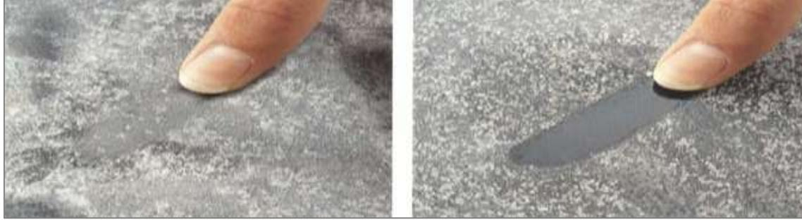
شكل (٥-٢٧) يوضح مقارنة بين يسارًا : سطح غير مطلي بطلاء ETC ، يمينًا : سطح مطلي ب طلاء ETC ، تعتبر طبقة ETC السيراميكية شبيهة بورق الحائط و هي تصمد أمام استخدام المياه و لذلك فإنها قد تكون صالحة للإستخدام الأمثل في دورات المياه shower cubicle وذلك لتقنيتهما العالية في طرد المياه .
