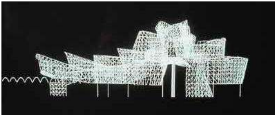
شكل(٢٨/٣) الهيكل الاتشائي المعدني والذي تم تطويره بواسطة برنامج كاتيا ( Catia )
