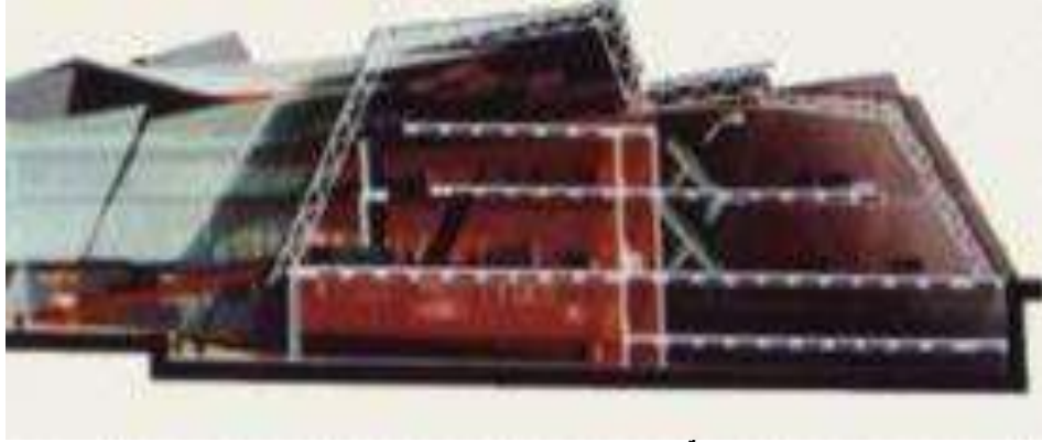
شكل(١٠٩/٣) الفكرة الانشائية لمشروع متحف العلوم - باستخدام الجمالونات من الحديد الصلب
