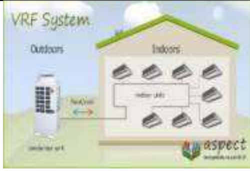
شكل (٣-١٤٥): وحدة داخلية لنظام VRV توضح كيفية الربط بين الوحدات الداخلية والوحدات الخارجية لتركيب في المبنى
