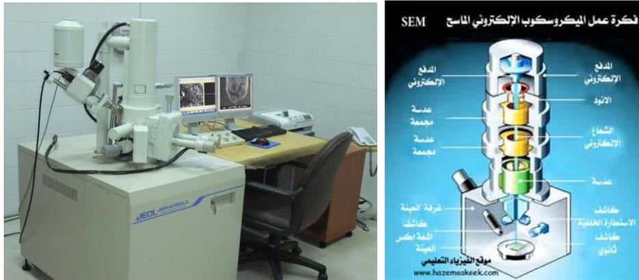
الشكل رقم (٢-٦-٤١) : صورة فوتوغرافية لأحد أنواع الميكروسكوبات الماسحة الالكترونيه الشائعة الاستخدام و رسم تخطيطى للجهاز موضحاً عليه شرح لمكوناته .
