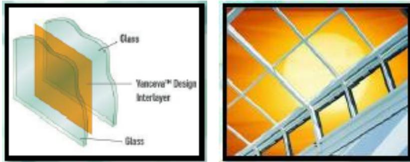
الشكل رقم (٢-٦-٦) يوضح زجاج امتصاص الحرارة
