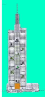
الشكل رقم (١-١-٢٤) يمثل قطاعاً للمبنى يوضح لنا علاقة الحدايق بالفناء المركزي وعلاقة التهوية الطبيعية بين الحدايق والفناء الداخلي المستخدم كمدخنة للهواء الفاسد الحار فيخرج من أعلى
