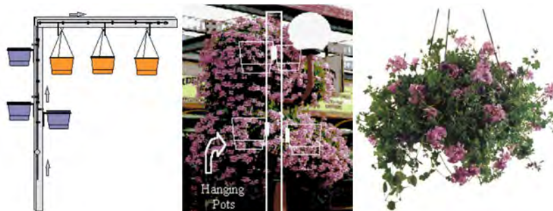
شكل (٢٢/٣) تكوين شجرة مزهرة متنقلة بتعليق أنية من زهور الجارونيا المتهدلة على عمود معدني، ويتم رى الآنية عن طريق شبكة للرى بالتنقيط مثبتة داخل العمود ٨٤
