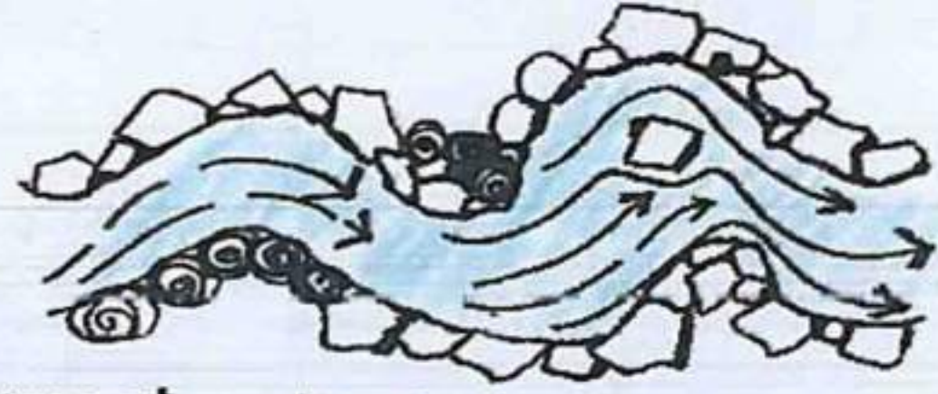
شكل يوضح مسط مجرى مائي به عوائق (عن الباحث) تيسبب اضطراب للمياه
