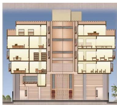
شكل ( ٢ - ٢٩ ) قطاع بالمبنى يوضح استخدام الفناء لتهوئة المبنى مع الحفاظ علي الخصوصية
