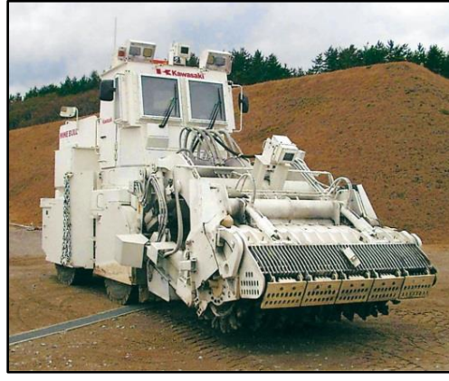
شكل ( ١٠ ) : كاسحة ألغام تقوم بعمل ثغرة في حقل الألغام ( ٢٨ )
