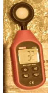
شكل ( ٢٤ ) جهاز قياس شدة الاضاءة طراز (Mini Light Meter) - المصدر : الباحثة
