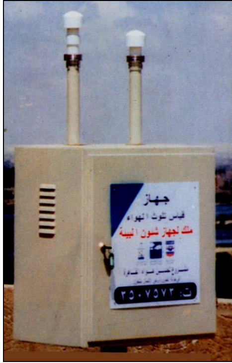
شكل ( ٤-٤ ) : جهاز قياس تلوث الهواء علي سطح أحد المباني (١)
