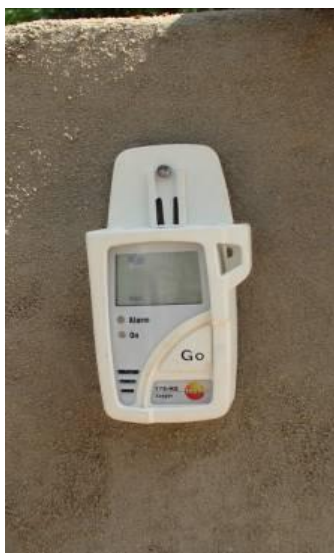
Figure 5.9 : L'appareil de mesure (Testo 175-H2) qui a été utilisé pendant l'expérimentation pour mesurer les températures et les taux d'humidité relative.
