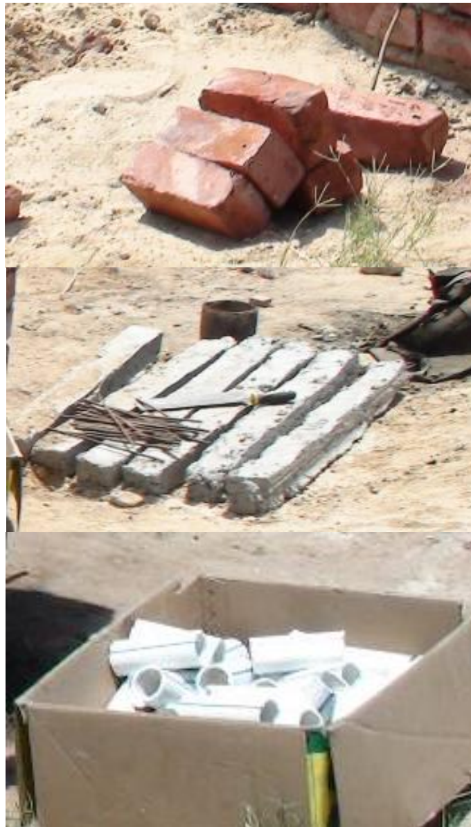
Figure 5.6: Briques rouges, béton armé et tuyaux en plastique sont les matériaux de construction utilisés
