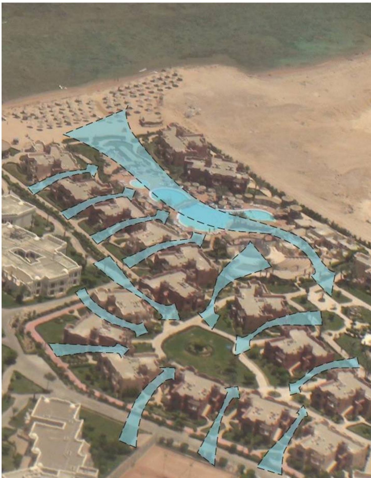
Figure 1.10 : La forme urbaine basse et dispersée nous donne une grande opportunité pour bénéficier du vent qui circule librement entre les bâtiments, village touristique d'holidayin, Nabaq-Bay, Sinäi.
