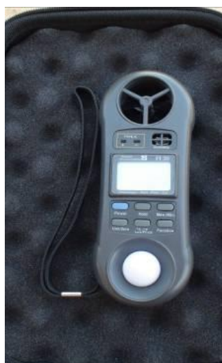
Figure 5.10 : L'appareil de mesure (Multifonctions LM/F1 20) qui a été utilisé pendant l'expérimentation pour mesurer les vitesses du vent.
