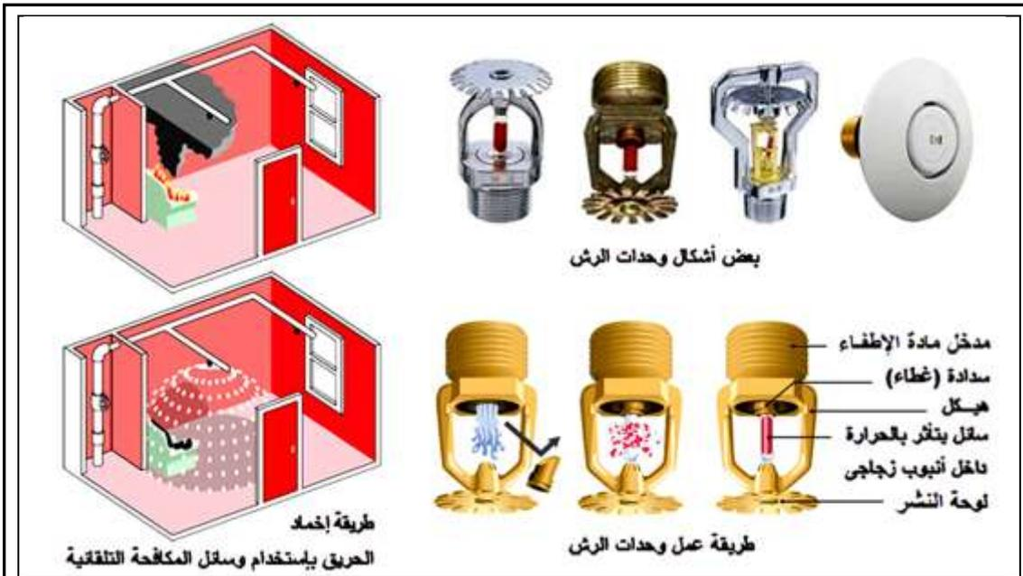
شكل (٥-٢٩): بعض أشكال، وطريقة عمل وحدات الرش التلقائية.
