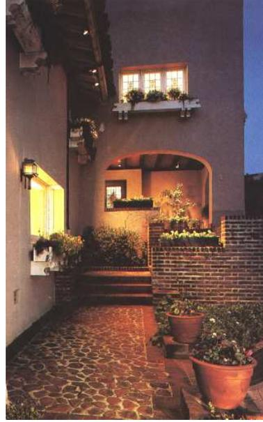
شكل رقم ٩-٦٣: تم استخدام eave mounted downlights with PAR-36 spots لإضاءة حوض الزهور و ممر المشاة و حائط الطوب و السلم و المدخل (residential lighting). الوجهة.
