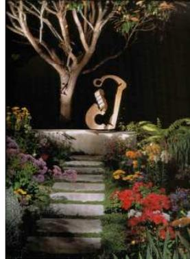
شكل رقم ٩-١١: استخدام الإضاءة التوكيدية للتأكيد على التمثال والشجرة الموجودة وراءه واستخدام الإضاءة الغامرة لإضاءة النباتات الموجودة على جانبي المشهد والتي تعمل كعناصر ثانوية في التكوين الضوئي. (Whitehead, 1993)
