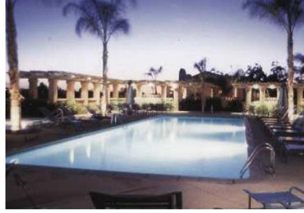
شكل رقم ٥-٣٢: إضاءة حمام السباحة باستخدام المصباح المتوهج بدون استخدام فلتر للون color filter يجعل لون المياه أصفر و غير صافي. (Whitehead, 2001)
