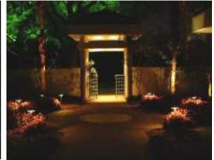
شكل رقم ١٢٥-٩: أماكن مختلفة لتثبيت تركيبات الإنارة لإضاءة المداخل، غير مفضل إضاءة المدخل من جانب واحد مع استخدام شدة إضاءة مرتفعة لتغطية المدخل كله بالإضاءة (Whitehead, 2001).
