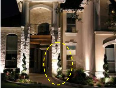
شكل رقم ٩-٢١: استخدام تقنية الصورة الظلية للتأكيد على نمط هيكل النبات بالإضافة إلى تقنية الإضاءة المماسية للتأكيد على شكله و ملمسه. (www.lightsauatin.com)
