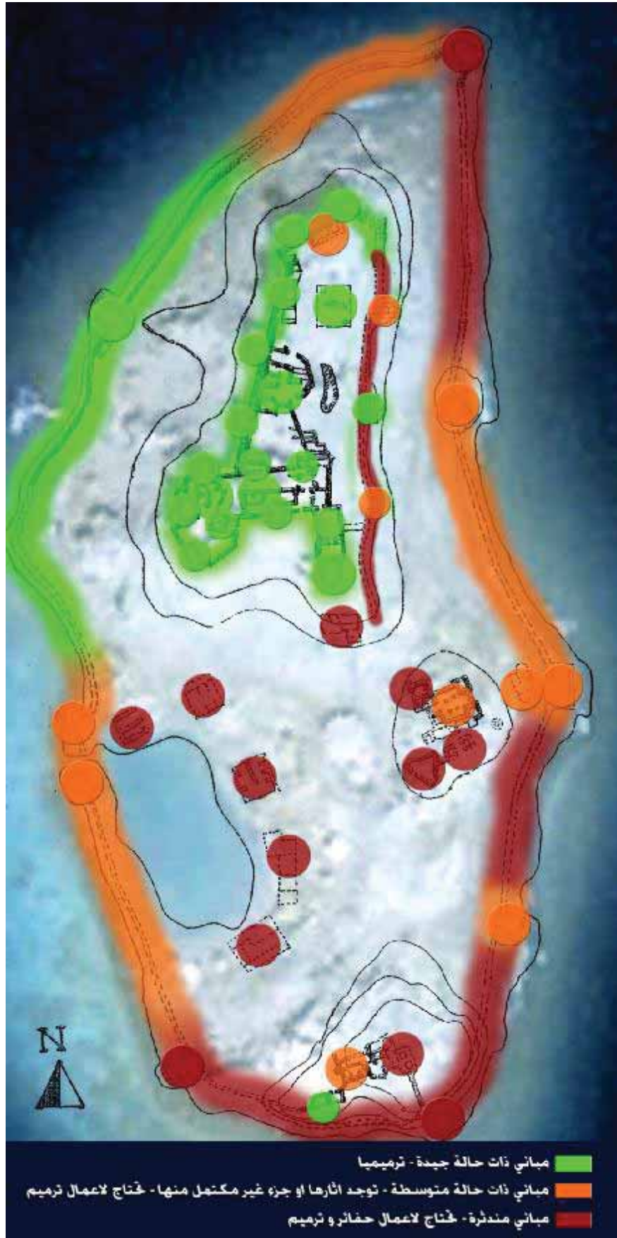
(شكل ٢ - ١١٩): دراسة تحليلية لنتائج رصد الوضع الراهن - دراسة حالة عناصر القلعة المعمارية. المصدر: الباحث.
