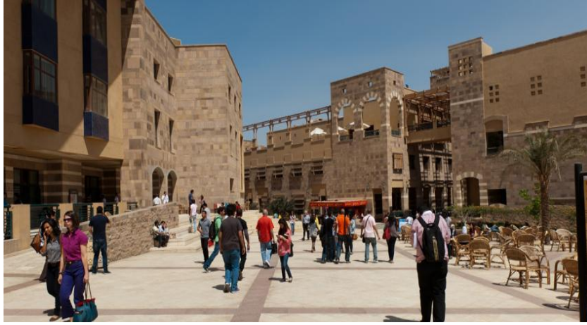
شكل رقم (٥-٢٨): تقليل تأثير الحرارة التي تشعها العناصر الأرضية والمعمارية بالمسار عن طريق استخدام الألوان الفاتحة والملمس الخشن في كل من الواجهات المطلة على المسار والأرضيات وعناصر الفرش بالجامعة الأمريكية بالقاهرة ( crja.com/project/auc-master-plan )
