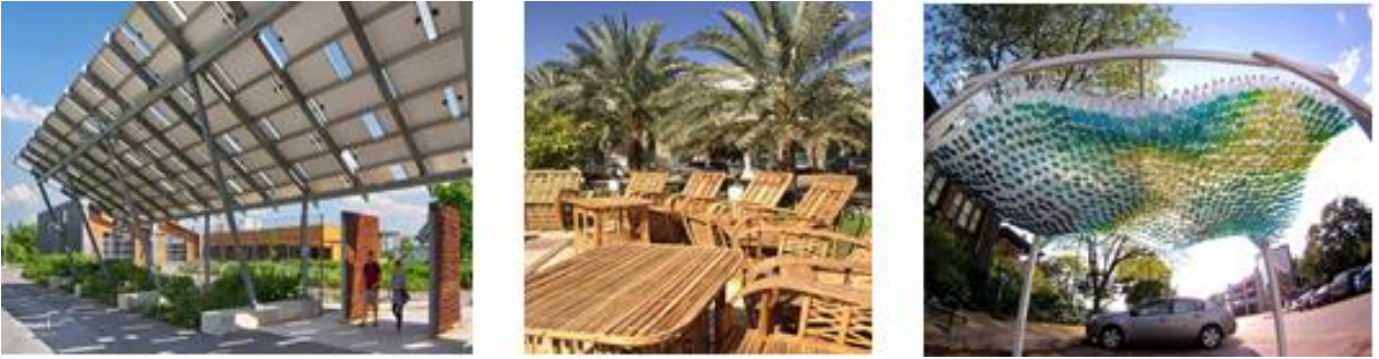
شكل رقم (٣٠-١): استخدام الزجاجات البلاستيكية لتظليل أماكن انتظار السيارات. وسط: استخدام مخلفات النخيل في عناصر الفرش الخارجي. يسار: دمج ألواح الطاقة الشمسية في المظلات لتوليد الطاقة الكهربائية. (www.pinterest.com)
