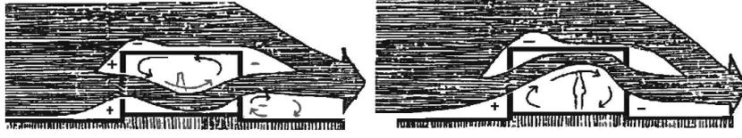
تعد مداخل الهواء أكثر أهمية بالمقارنة بالمخارج بأخذ أنماط مسارات الهواء في الاعتبار ، يتم توجيه تيار الهواء من خلال الشمسية في المكان الذي يتطلب التهوية في الحيز المعماري .
