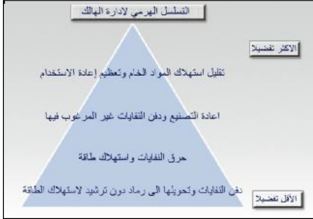
شكل (١٠) إدارة الهالك بمرحلة الهدم والتخلص
