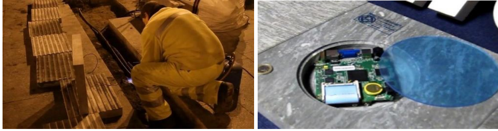
المعالج المثبت في نواة الحجر الذكية بتلك الأرصفة عملية تركيب الأرصفة الذكية شكل (١-٢٥) الأرصفة الذكية (ipavement.com) (٢)
