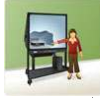
شكل ٥٧: سبورة تفاعلية تعمل مع وجود جهاز كمبيوتر مصغر وجهاز إسقاط ضوئي ملحقان بالسبورة ذاتها من الخلف. (١٨)
