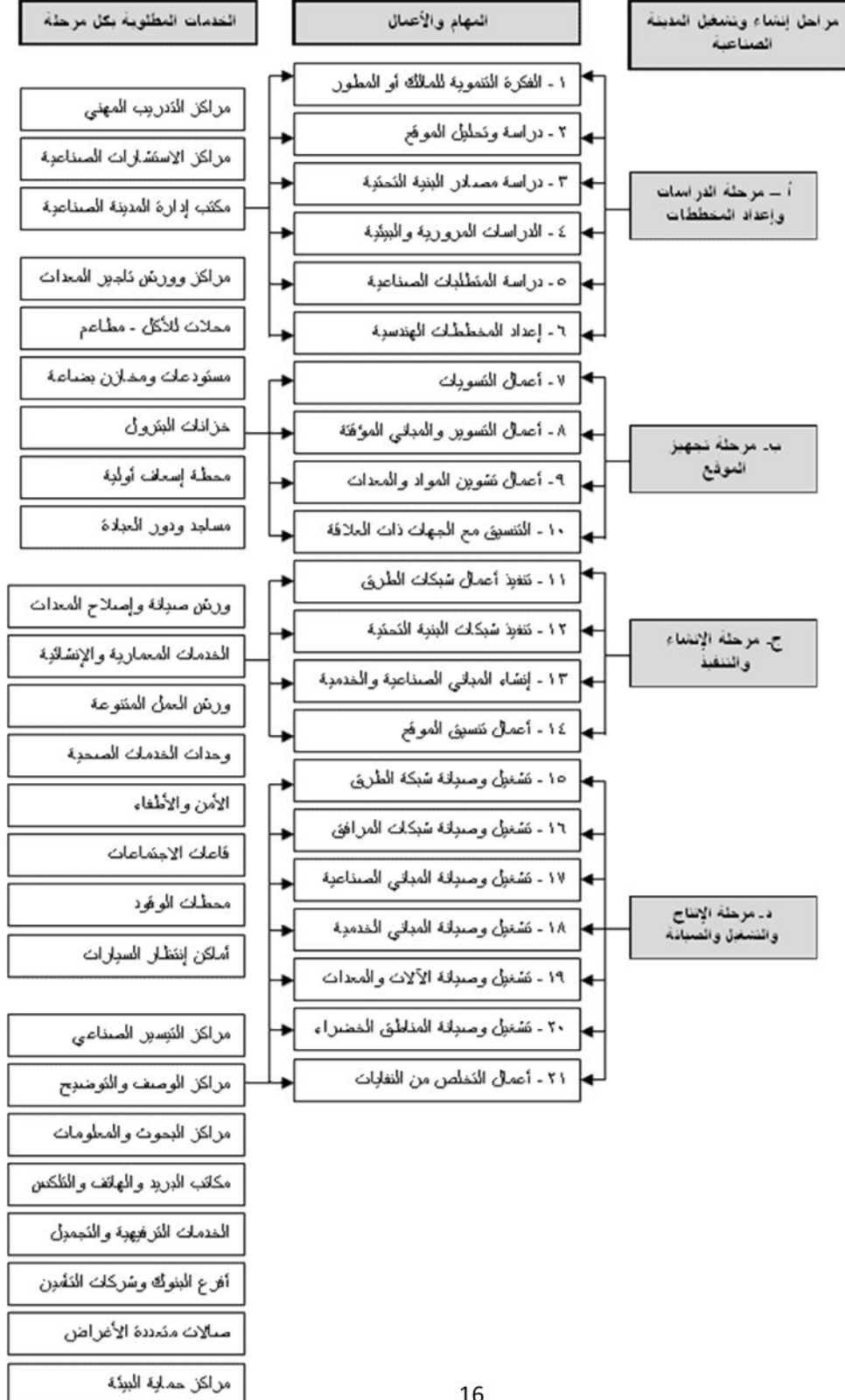
شكل رقم (٦) توزيع الخدمات الصناعية علي مراحل إنشاء وتشغيل المدينة الصناعية
