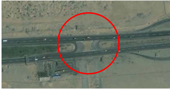
شكل رقم (12-29) يوضح نموذج لفتحة بالجزيرة الوسطى تؤدي بصورة قاطعة لحدوث اختناقات مرورية بطريق القاهرة السويس.
