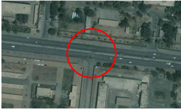
شكل رقم (27-12) يوضح نموذج لفتحة بالجزيرة الوسطى تؤدي بصورة قاطعة لحدوث اختناقات مرورية بطريق القاهرة السويس.
