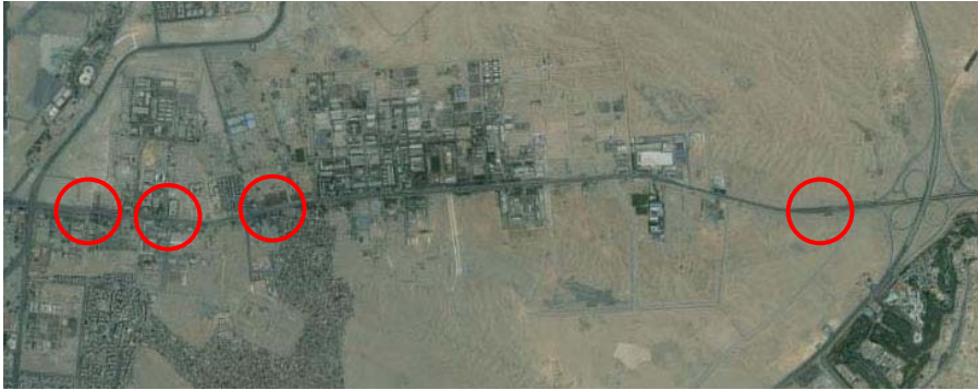
شكل رقم (12-26) يوضح بعض الفتحات بالجزيرة الوسطى و U- Turns تؤدي بصورة قاطعة لحدوث اختناقات مرورية بطريق القاهرة السويس.
