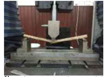
شكل 5- 84 عمل اختبار الانحناء على مسافة تثبيت 400 مم
