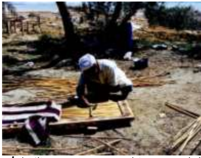
شكل 1- 15 عامل سيوي يستخدم جريد النخيل في عمل الابواب و النوافذ المصدر: Alamuddin, Hanan, Adrere Amellal Eco Lodge Technical Review Report (Siwa Oasis, Egypt: Siwa Sustainable Development Initiative, 2001) (p. 31).
