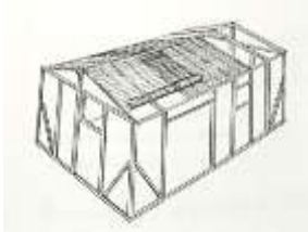
شكل 2-44 تجليد السقف بالسدد البوص، و يراعى ان يتم التجليد بعد البياض حتى لا تتعرض السدد البوص في السقف للطرطشة المصدر: هلال، أحمد عبدالنبي، "العمارة التلقائية في مصر: عمارة البوص في منطقة بحيرة المنزلة" (رسالة ماجستير، جامعة حلوان، كلية الفنون الجميلة، 1992، ص.240).
