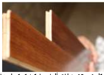
شكل 1- 40 عينات ألواح باركيه تم تصنيعها في أحد المصانع بمدينة الاسكندرية من حصر سدائب جريد النخيل المصدر: عبد الوهاب، زايد، 'كتاب الفائزين،' جائزة خليفة الدولية لنخيل التمر، الامارات العربية، الدورة الخامسة (2012-2013. (ص.103).
