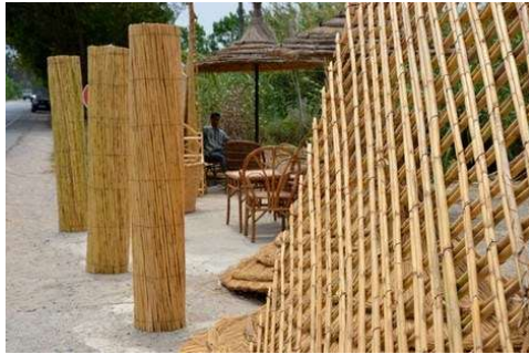
شكل 2- 41 صناعة الشبيكة من البوص
