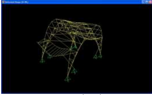
شكل 5- 93 شكل المنشأ تحت تأثير وزنه و الرياح المصدر: الباحث من خلال برنامج SAP2000
