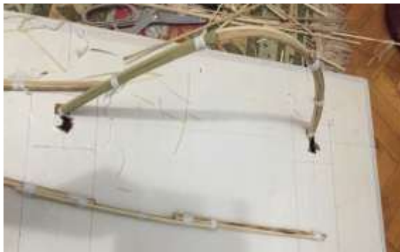
شكل 5- 63 تحضير الارضية و بدء تثبيت الحزم العقدية: نجاح أول عقد بدون حدوث تشققات عند استخدام الحزمة الوسطى من 6 جريدات فقط المصدر: الباحث
