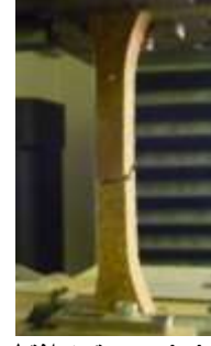
شكل 2- 51 عينة Wood Plastic تحت اختبار الشد
