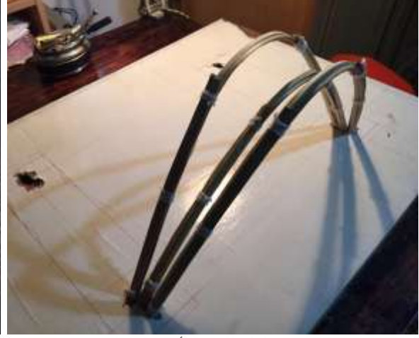
شكل 5- 64 عمل العقدین الثلاثیین: تركيب أول عقد ثلاثي من 3 عقود بأساس مشترك. المصدر: الباحث
