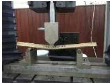
شكل 5- 83 اختبار الانحناء على مسافة تثبيت 280مم
