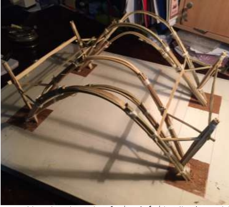
شكل 5- 69 تثبيت القوائم الرأسية: تثبيت الأربع قوائم بالدعامات التي تدخل حزم العقود بالاضافة إلى الكمرات. المصدر: الباحث
