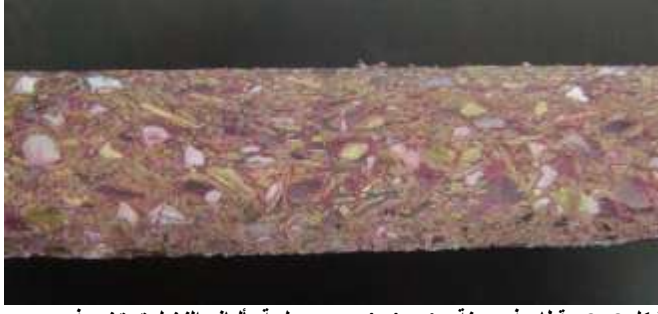
شكل 2- 52 قطاع في عينة Wood Plastic مسلحة بألياف النخيل تستخدم في الاغراض الإنشائية الخارجية
