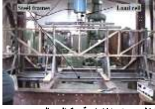
شكل 5- 46 اختبار قدرة الجمالون الثاني. المصدر: Raga, Tamer (MSc Thesis, Ain Shams University, Department of Engineering, 2010), p. 135.
