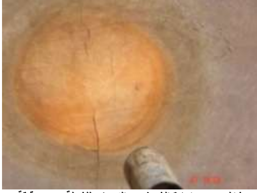
شكل 2- 25 زيادة الشرخ بعد التعرض للشعلة بـ 90 دقيقة
