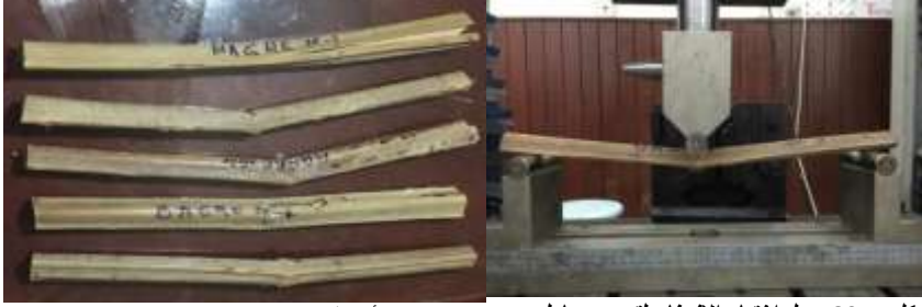
شكل 5- 81 أنماط انهيار العينات
