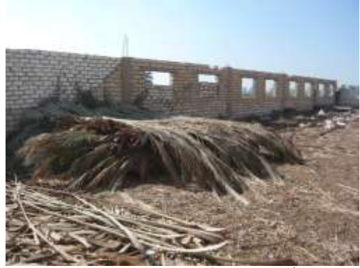
شكل 5- 10 أسلوب الترقيد في تجفيف السعف. المصدر: الباحث في زيارة ميدانية لقرية القبايات.
