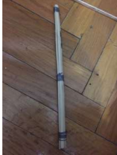
شكل 5- 60 تصميم الحزم: تم تصنيع الحزم الخاصة بالعقود باستخدام 3 حزم متراكبة كل حزمة بطول 25 سم. المصدر: الباحث
