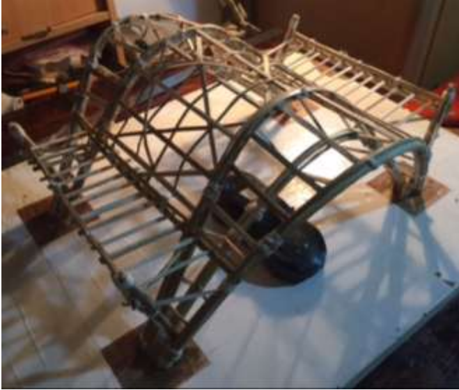
شكل 5- 73 تثبيت الدعامات الإضافية: الشكل النهائي بعد اكتمال النظام الإنشائي ( يلاحظ وضع سيارة مقياس 20:1 للشعور بالحجم الحقيقي للنموذج) . المصدر: الباحث
