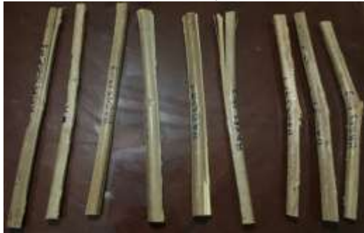
شكل 5- 85 أنماط انهيار العينات
