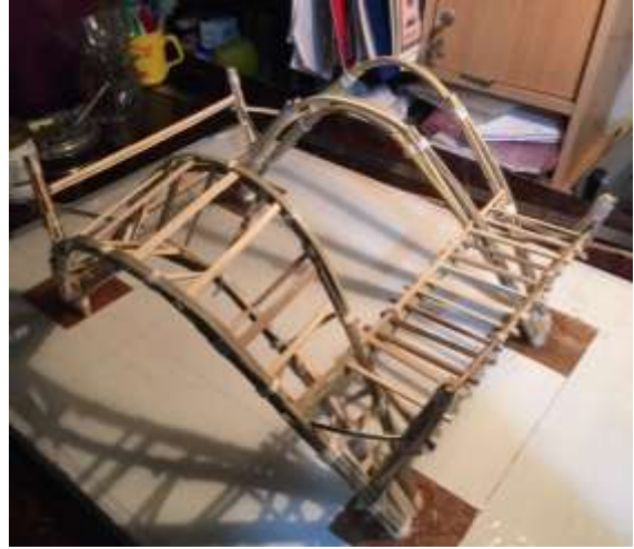
شكل 5- 70 تثبيت الدعامات الإضافية: تغطية السقف المستوي بالكمرات الأفقية بالاضافة إلى تثبيت الدعامات المائلة و الأفقية لربط عقود كل عقد ثلاثي. المصدر: الباحث
