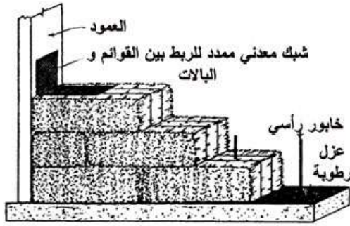
شكل 3- 19 تثبيث البالات بالقوائم الرأسية للاطار الانشائي باستخدام الشبك المعدني الممدد المصدر: Ashour, Taha, 'Using Straw as Building Material', in Straw: Production, Cultivation and Uses , ed. by Steven B. Elfson (London, UK: Nova Science Publishers, 2011), p. Chapter 2 (p. 18).
