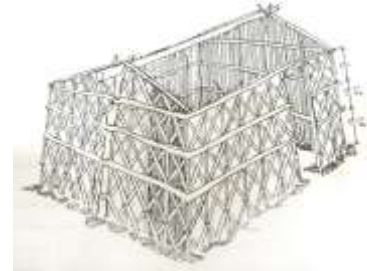
شكل 2-37 تثبيت الدعامة الأفقية للجمالون فوق القامان بواسطة نطاق رابع من الكيش. المصدر: هلال، أحمد عبدالنبي، "العمارة التلقائية في مصر: عمارة البوص في منطقة بحيرة المنزلة" (رسالة ماجستير، جامعة حلوان، كلية الفنون الجميلة، 1992، ص.212) 2. تفاصيل الحماية
