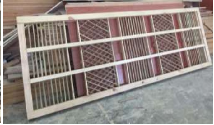
شكل 5-114 النموذج الثاني للبانوه باستخدام العوارض الأفقية من الخشب لتسهيل الصيانة المصدر: الباحث من ورشة النجارة، بكلية الهندسة جامعة عين شمس.
