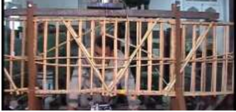
شكل 5- 49 استخدام دعائم قطرية اضافية. المصدر: Raga, Tamer (MSc Thesis, Ain Shams University, Department of Engineering, 2010), p. 145.
