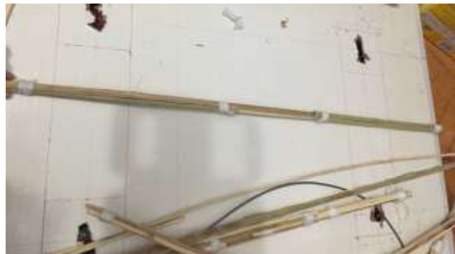
شكل 5- 62 تحضير الارضية و بدء تثبيت الحزم العقدية: تصميم الحزمة المتوسطة من 6 جريدات فقط المصدر: الباحث
