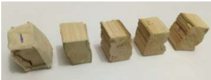
شكل 5- 89 أنماط انهيار العينات
