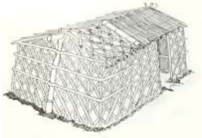
شكل 2-39 توضع السد البوص فوق الشبيكة كأخر طبقة من طبقات السقف، و يمكن وضع أكياس البلاستيك بينهما. المصدر: هلال، أحمد عبدالنبي، "العمارة التلقائية في مصر: عمارة البوص في منطقة بحيرة المنزلة" (رسالة ماجستير، جامعة حلوان، كلية الفنون الجميلة، 1992، ص.215)
