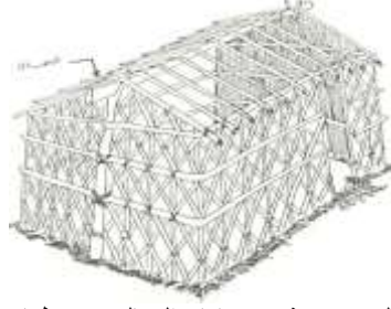
شكل 2-38 كيش و دعامات الجمالون و ربطها بالدعامة الأفقية للجمالون المصدر: هلال، أحمد عبدالنبي، "العمارة التلقائية في مصر: عمارة البوص في منطقة بحيرة المنزلة" (رسالة ماجستير، جامعة حلوان، كلية الفنون الجميلة، 1992، ص.214)
