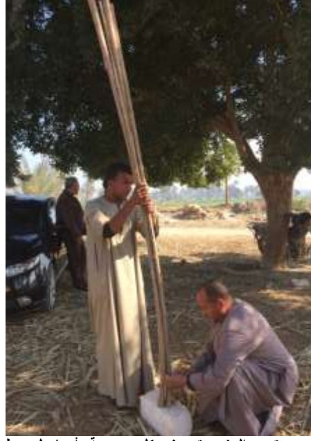
شكل 5- 17 تجميع الحزم: يتم وضع كل مجموعة رأسياً على سطح مستوي لتسوية النهايات المصدر: الباحث.
