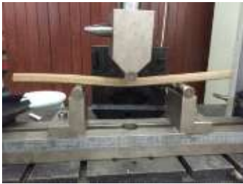
شكل 5- 82 عمل اختبار الانحناء على مسافة 280مم
