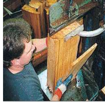
شكل 3- 7 تقطيع شرائح خشب الارز يدويا المصدر: Application Manual (Mission, Canada: Independent Shake and Shingle Producers Association, 2014) (p. 3). ب. تفاصيل الحماية
