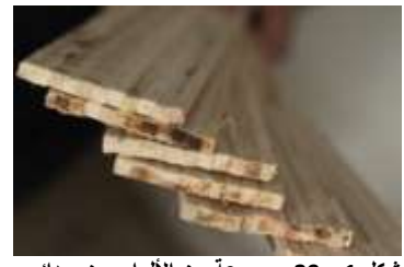
شكل 1- 39 مجموعة من الألواح من سدائب جريد النخيل مقاس 10سم*60سم*8مم المصدر: عبد الوهاب، زايد، 'كتاب الفائزين،' جائزة خليفة الدولية لنخيل التمر، الامارات العربية، الدورة الخامسة (2012-2013. (ص.103).
