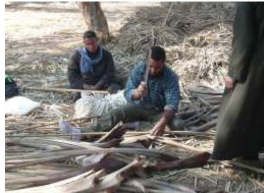
شكل 5-15 قص الجريد: يتم استخدام المتر لتقطيع الجريد بالأطوال المطلوبة. المصدر: الباحث.
