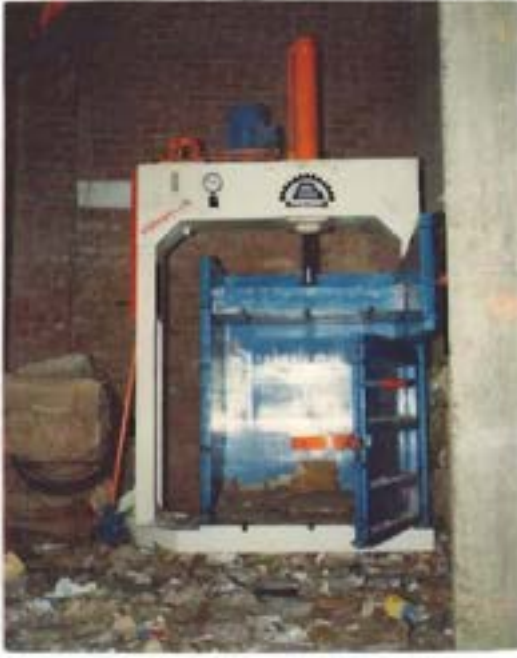
شكل (٥ - ٤٤) : مكبس ورق هيدروليكي يعمل بالكهرباء.
