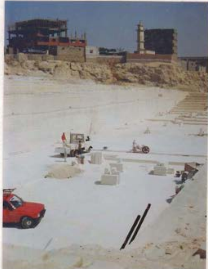
شكل ( ٤ - ٧٠ ) : منظر للمحجر من الداخل ويرى منشار الكهرباء الذي يقطع به الحجارة من قاع المحجر ، ولذلك يبدو المحجر متساوي القسطع بالجدران والقاع ، وتأتي سيارات لشراء المنتج من الموقع وتنزل بمنحدر إلى القاع ، الجامع الذي يظهر بالخلف تم انشاؤه حديثاً " بمنطقة الزهالين " ( صورة حديثة عام ١٩٩٠ )
