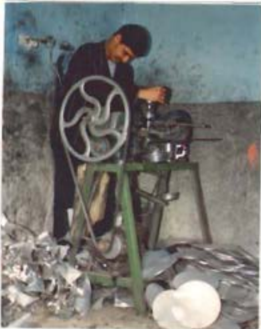
شكل (٥ - ٤٢) : ورشة إعادة تصنيع الألمونيوم المسترجع ، ويظهر بالشكل على اليمين الألمونيوم بعد تحويله إلى شرائح مستديرة ويتم تصنيعها إلى أدوات منزلية
