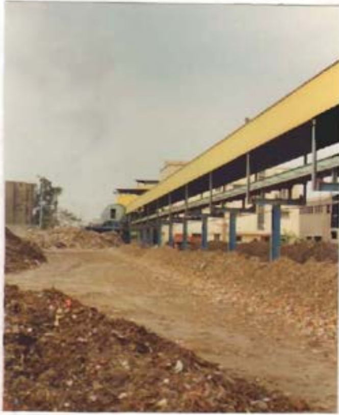
شكل ( ٤ - ١٦ ) : تمر المادة الخام للسماذ على سير أفقى مثبت عليه " عمرة توزيع السماذ " لتوزعه على خطين بين ويسار السير على شكل كومة لتكون بذلك " الخط الأول " وتبقى المادة الخام أسبوعا ثم تنتقل إلى ثلاثة صفوف أخرى على التوالي وتبقى أسبوعا بكل خط
