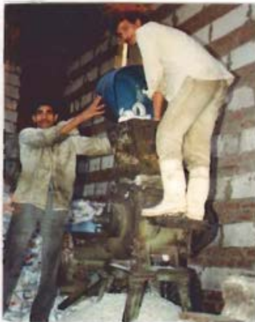
شكل (٥ - ٣٨) : ماكينة تكسير البلاستيك ويتم تزويدها بالبلاستيك من أعلى ، ويظهر البلاستيك المطحون أسفلها
