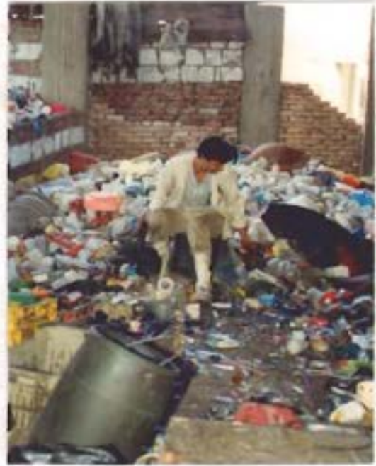
شكل (٥ - ٣٧) : فصل البلاستيك الأبيض عن الملون وتقطيعه
