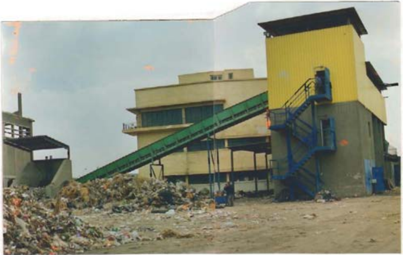
شكل ( ٤ - ١٢ ) : تتجمع قمامة المنطقة الشمالية التي تقوم بجمعها " البلدية " من صناديق القمامة المنتشرة في الشوارع في فناء المصنع ، ويقوم جرار بوضعها على السير المائل الموضح بالشكل لرفعها إلى دور الفرز
