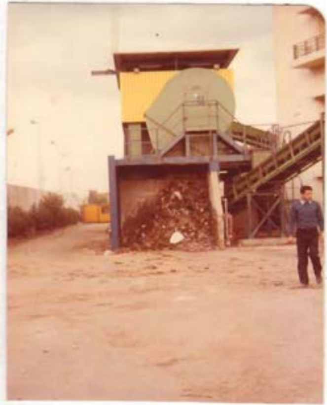
شكل ( ٤ - ١٥ ) : تمر القمامة بقلاب ، حيث تقطع وتقلب بالمياه وتفصل عنها الشوائب بأسفل المقلب
