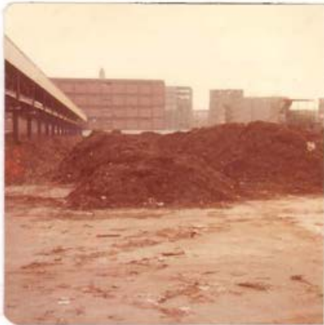
شكل ( ٤ - ١٨ ) : المخطوط الأربع للمادة الخام للسماذ على بين السير والتي يوجد مثلها على يسار السير ، وتتحول المادة الخام فى نهاية الخط الرابع الى سماذ خشن
