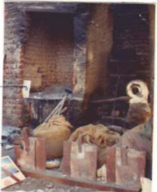
شكل (٥ - ٤١) : ورشة تحويل الألمونيوم إلى سباتك ، ويظهر في الخلف فرن صهر الألمونيوم وعليه سبيكة مستطيلة الشكل ، بينما يظهر في مقدمة الشكل قوالب صب السباتك
