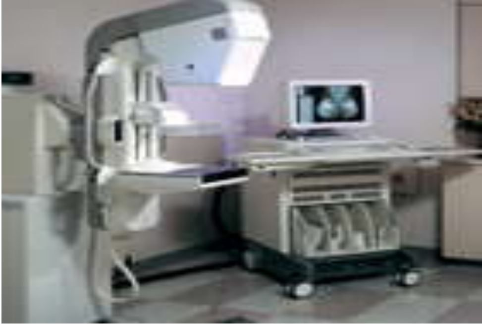
شكل رقم (٥٠) جهاز الماموجراف إنتاج شركة جنرال إلكتريك GE's Senographe digital mammography
