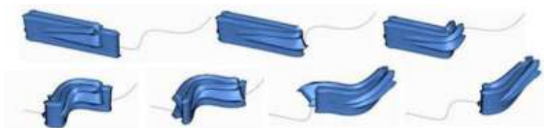
(شكل ٤-٣٤) عملية التحول على الشكل من خلال التغيير في مسار التشكيل باستخدام أوامر التغيير مثل الانحناء والالتواء المصدر : حازم الدالي، مرجع سابق
