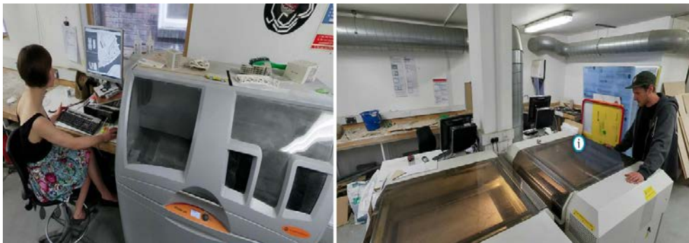
شكل رقم ٧٩ ورشة تقطيع ليزر بجامعة نيوكاسل بانجلترا به 3 powerful CNC laser cutters و Zcrop 3D Printer (Newcastle University/School of Architecture, 2015)
