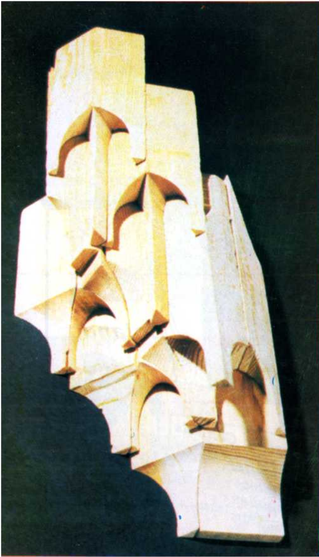
بناء شاشيه القبة قبل تركيبها و تثبيت المقرنصة عليها
