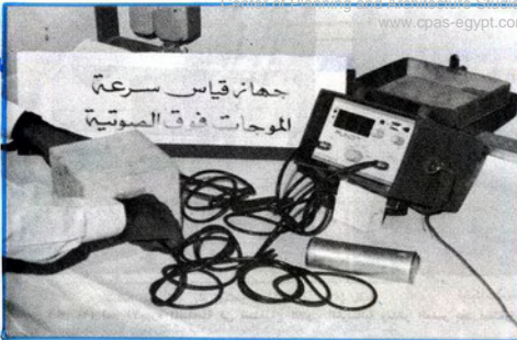
أحد الأجهزة المستخدمة لقياس سرعة الموجات لقياس سرعة الموجات فوق الصوتية
