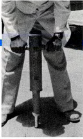
شكل (٢) أحد الأجهزة المستخدمة في استخراج القلوب الخرسانية ونظر العنصر بعد استخراج القلب منه. شكل (٤) أحد أنواع الطريقة الرابطة (شديد)
