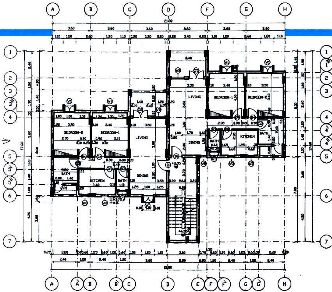
● رسومات تنفيذية مرسومة بمساعدة نظام CAD - من أعمال مركز الدراسات التخطيطية والمعمارية . مقطع أفقي وواجهة في أحد الصارات السكنية - قرية شاطئ الرواد .
