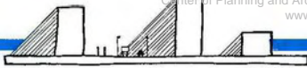
الأبراج الشاهقة التي تعلفها شوارع عريضة .. شكل عمراى بالغ السوء من حيث الإمتصاص الحرارى .
