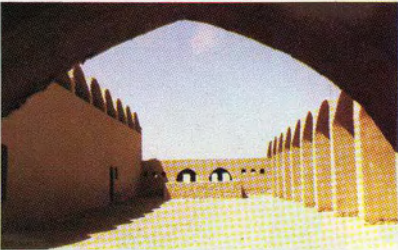
استخدام الطوب الطغلى فى بناء الحوائط والقنوات والمقود فى أحد مساكن كبار المواطنين فى باريز الجديدة .
