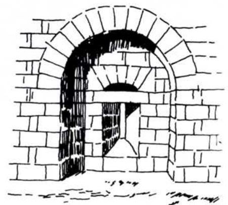
تفصيلة أحد المزاغل ( دخلة غائرة في السور للدفاع بالسهام ) الباب الحديد -
