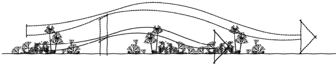
يساهم إرتفاع الحاجز الهوائي وزاوية الحافة العليا في تحديد المسافة المحمية خلفه
