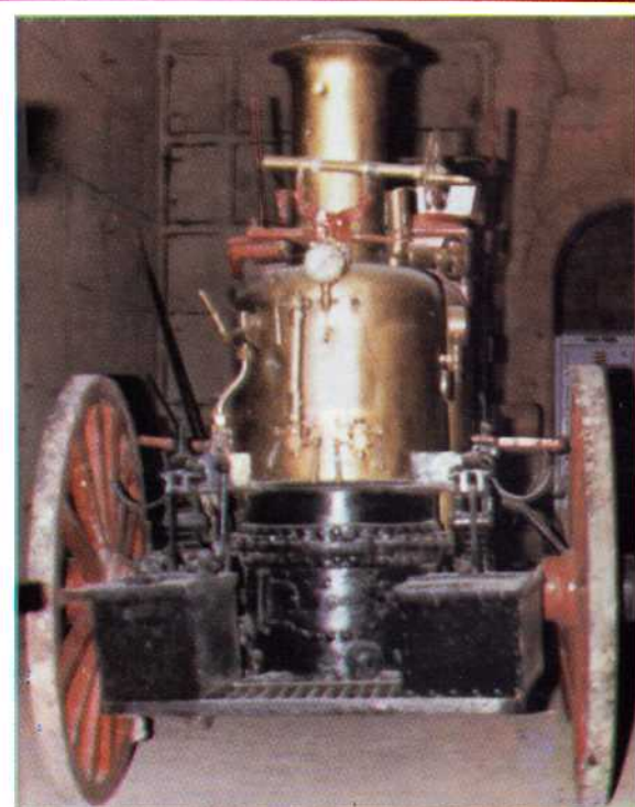
عربة إطفاء ذات طلمبيه نحاسيه تدار بالبخار
