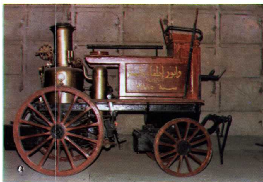
عربة إطفاء ذات طلمبيه نحاسيه تدار بالبخار
