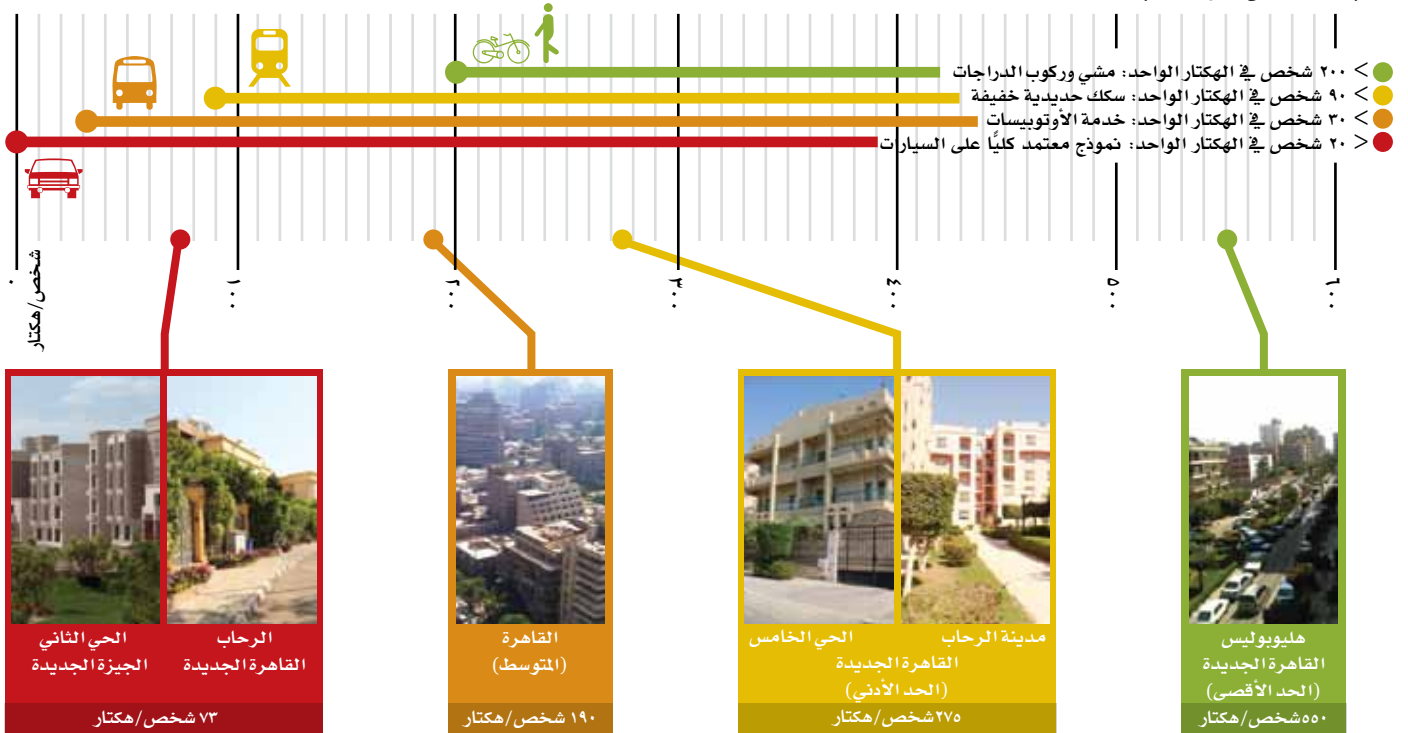
الشكل (٤-٢-٥): نماذج لبعض أحياء القاهرة والكثافة السكانية (عدد الأشخاص في الهكتار الواحد) لمختلف وسائل النقل، مثل المشي وركوب الدراجات والسكك الحديدية الخفيفة والحافلات العامة والسيارات***
