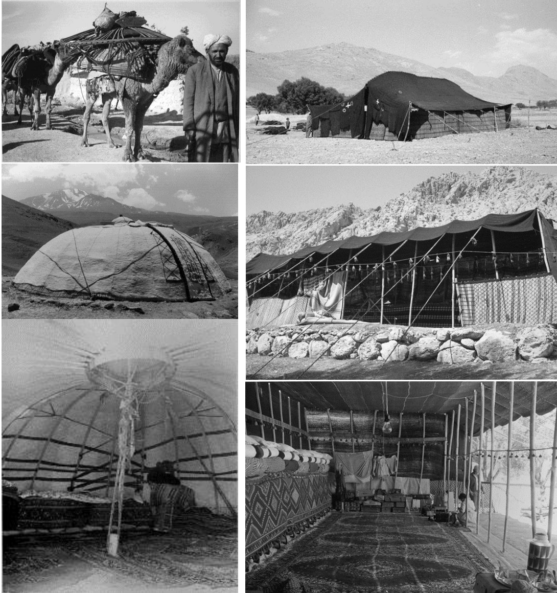
شكل (٤) يختلف شكل الخيمة طبقاً لمناخ البيئة الصحراوية ، حيث الخيمة ذات الأشكال المستطيلة والمنفتحة تستخدم في مناطق المناخ الحار ، أما ذات أشكال القباب المنغلقة الصغيرة فالمناخ البارد [١٣]
