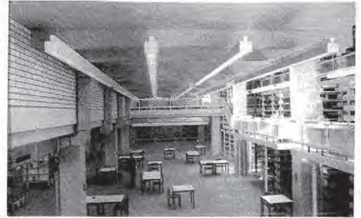
شكل (١٤٢) مكتبة جامعة كونستانز: أحد صالات القراءة يظهر المنشأ والأعمال الكهربائية والتكييف بدون إخفاء ولكنه معالج كجزء من التصميم.
